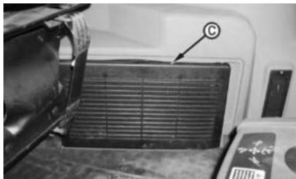
С—Крышка фильтра циркулирующего воздуха кабины
