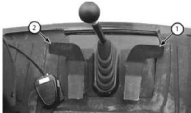
Показаны дополнительные органы управления гидросистемой навесного оборудования
